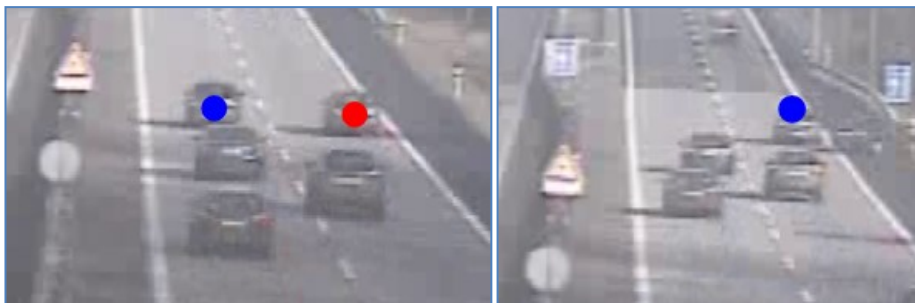
Obrázek 19 – Příčné přemístění vozidla s modrou tečkou za čas 2,2 sekundy 67
